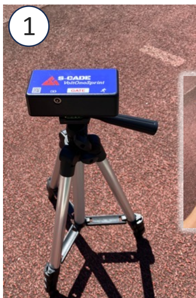
光電管を三脚に設置します
