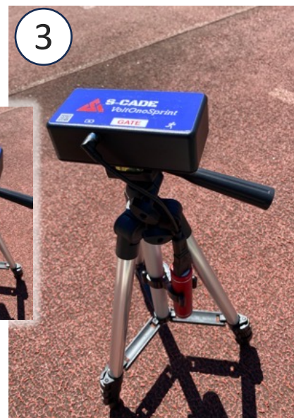
マグネットケーブルで 電源供給します
